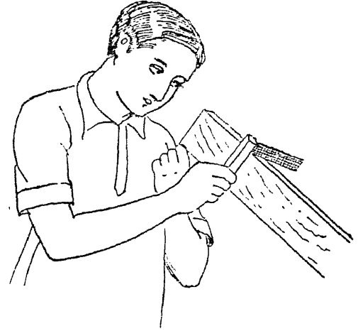
चित्र ५४—पटरीके बगलपर रंदा करते समय बार-बार इसको जाँच गोनियेस करते रहना चाहिये। (अगका चित्र देखो।) छोड़ लिया जाता है तब फल फ्रेट-साँमें कसा जाता है।
